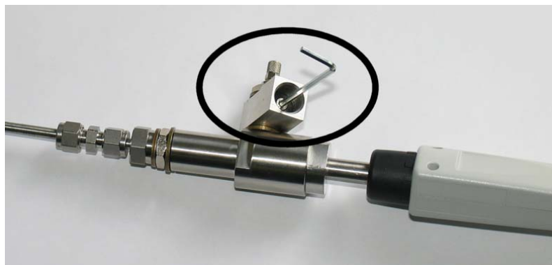
图30 通气量调整螺钉的拆卸
