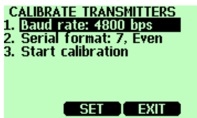
图11 变送器校准屏幕
